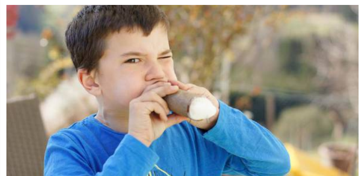
Holz atmet: Taucht man ein Holz auf einer Seite in Seifenblasenlösung und pustet auf der anderen hinein, entsteht eine Schaumkrone. proHolz
