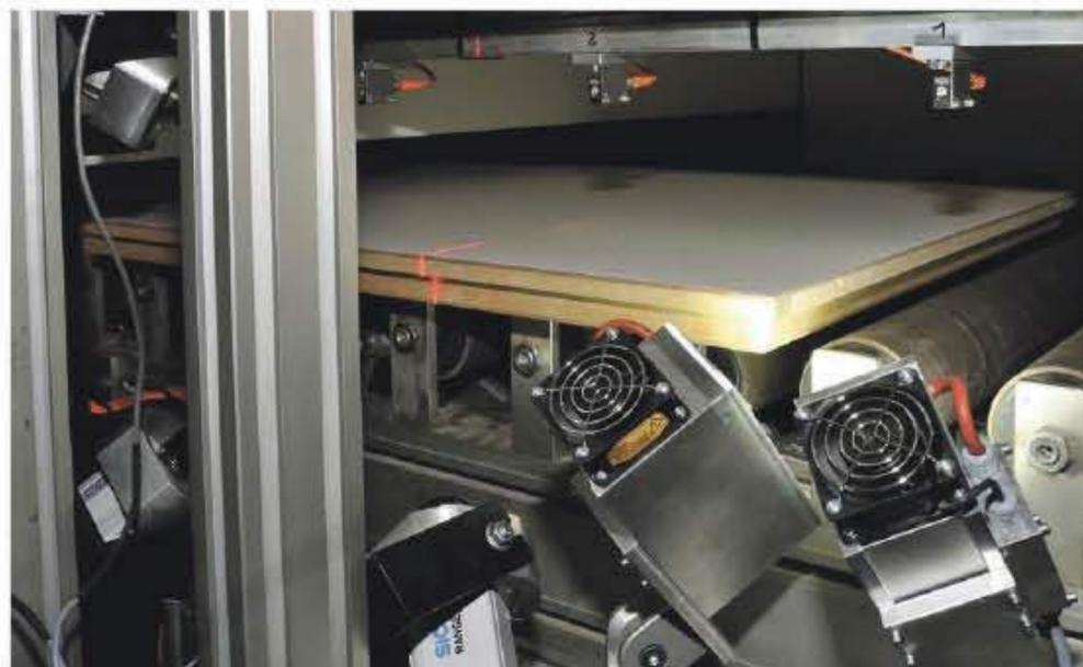
**Qualitätskontrolle in Sekundenschnelle:** Das Scanverfahren wird beispielsweise bei der Produktion von Dana Türen eingesetzt. Joanneum Research
