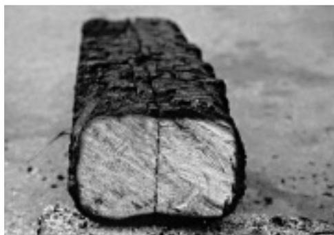
Feuer erlischt. Damit schützt sich das Holz selbst vor der völligen Zerstörung, denn sein Kern bleibt unbeschädigt und tragfähig.
